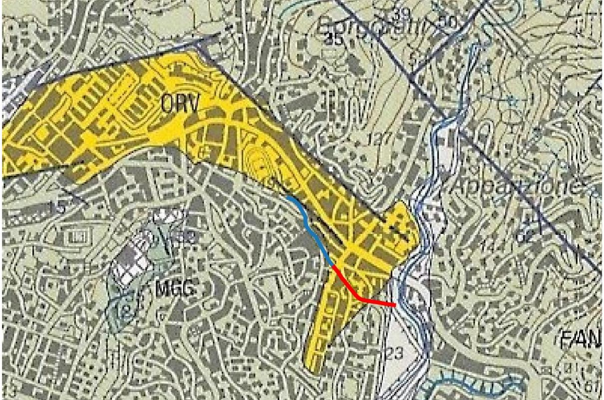
Figura 4.1: Stralcio della Carta geologica in scala 1:50000, progetto CARG, Foglio 213 "Genova". La parte di alveo tombinata è stata indicata in blu, mentre il tracciato della galleria idraulica è stato riportato in rosso. Immagine non in scala.
