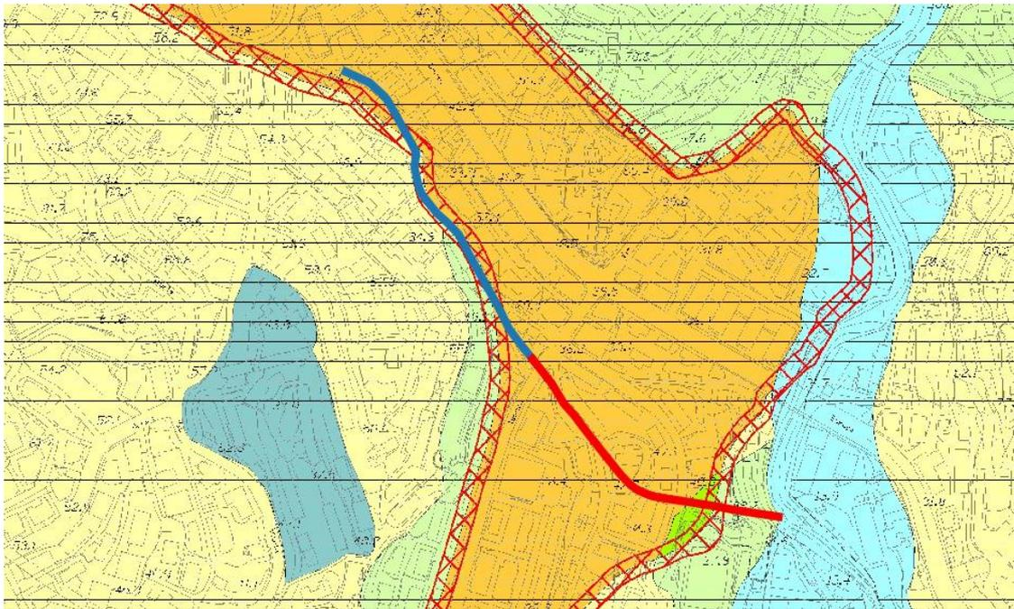
Figura 4.10: Stralcio della Carta Idrogeologica in scala 1:5000, Foglio n°39 del PUC del Comune di Genova. La parte di alveo tombinato è stata indicata in blu, mentre il tracciato della galleria idraulica è stato riportato in rosso. Immagine non in scala.
